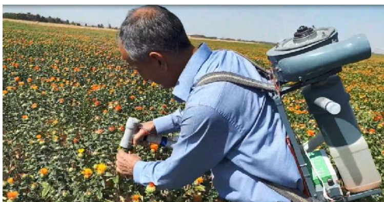
شکل ۲۴- عملیات برداشت در مزرعه توسط ماشین پستی برقی اصلاح شده
