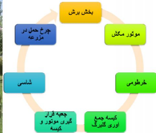
شکل ۲۶- اجزای دستگاه برداشت گلچه‌های گلرنگ
